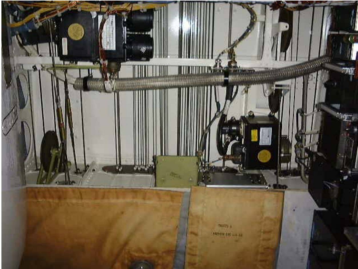
Unter dem Cockpit, nach oben sehend: Oben links im Bild der Aileron-Servo (dual) - rechts im Bild der Stickpusherservo.
